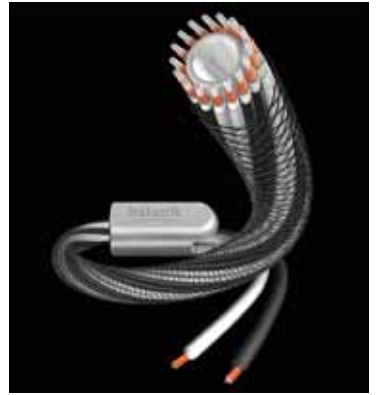
16股導體以每兩股正、兩股負的排列方式，每兩股的磁場方向是相反，剛好可以相互抵銷，降低磁場對傳輸的影響。
